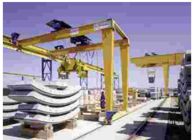
Semipórtico equipado con doble polipasto de 4 + 4 Tn.
